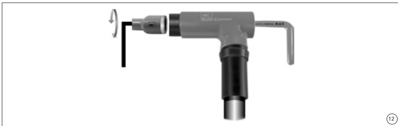
(ill. 12) Dévisser complètement l'adaptateur AF8/12 du CV400.
