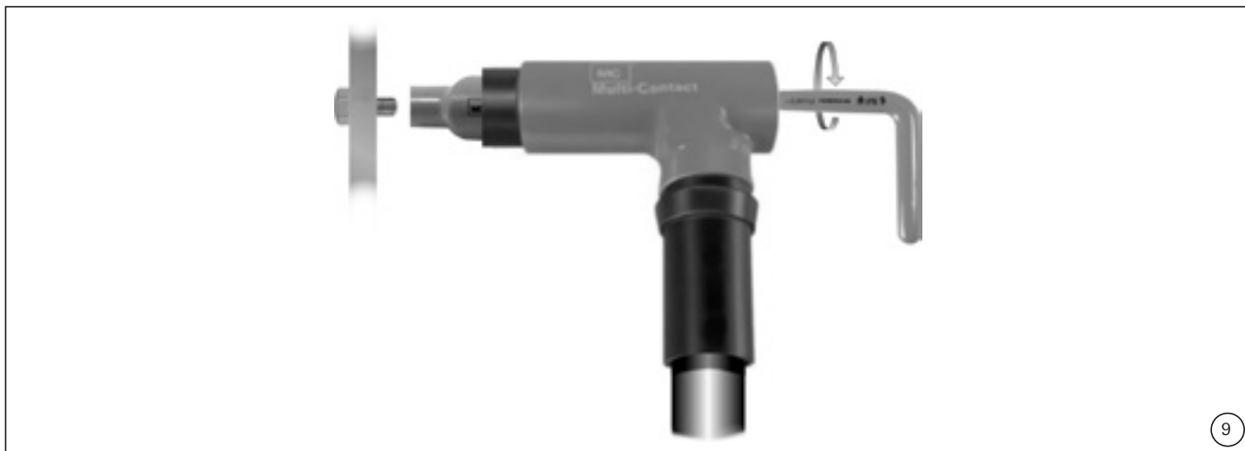
(ill. 9) Variante 1: Beim Lösen mit dem isolierten 6-kant Winkelschlüssel bleibt der CV400 auf dem Adapter verschraubt.
