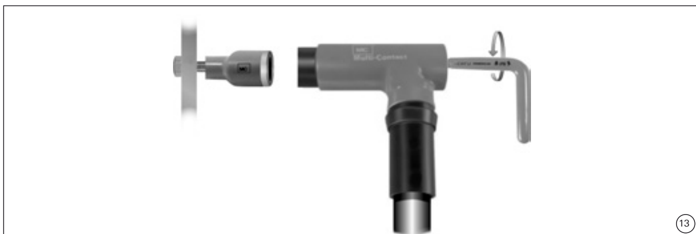
(ill. 13) Variante 2: Beim Lösen mit dem 6-kant Winkelschlüssel löst sich die Verschraubung am CV400 und der Adapter bleibt auf dem Schraub-bolzen.
