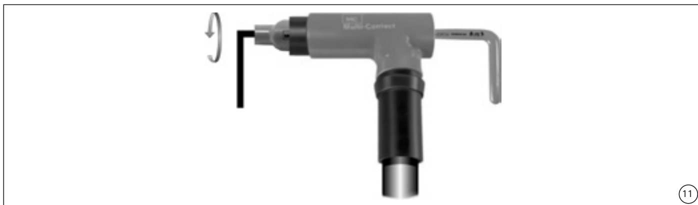
(ill. 11) Mit dem isolierten 6-kant Winkelschlüssel und einem anderen 6-Kant Schlüssel den Adapter vom CV400 lösen.
