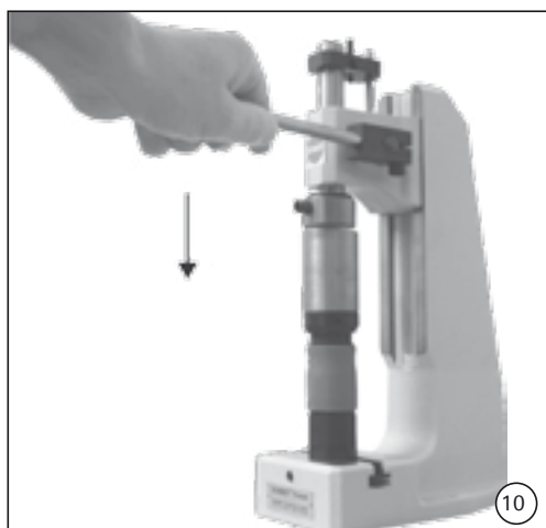
(ill. 10) Serrer la bague de verrouillage avec la presse manuelle jusqu'au point d'arrêt.
