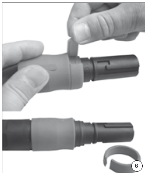
(ill. 6) Arracher l'isolant le long de l'encoche.
