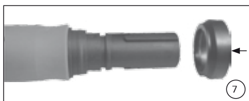
(ill. 7) Monter la bague de verrouillage sur la face avant de la douille...
