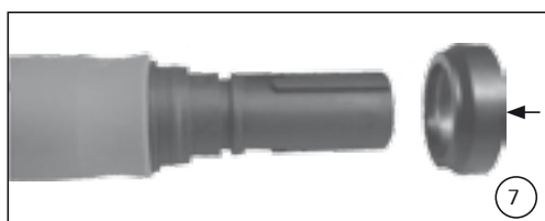
(ill. 7) Verriegelungsring von vorne auf den Buchsenkörper stecken...
