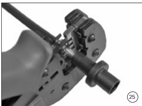
(εικ. 25) Αφαιρέστε την υποδοχή βύσματος . Εισάγετε το απογυμνωμένο καλώδιο στην αριστερή πλευρά μέχρι η μόνωση να έρθει σε επαφή με τους σιαγώνες. Κλείστε την πρέσσα τελείως. (Ελέγξτε το πρεσσάρισμα (δες εικ. 23).
