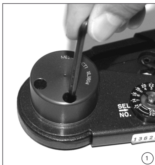
(ill. 1) Fixer le locator à l'aide de la clé à 6 pans fournie.
