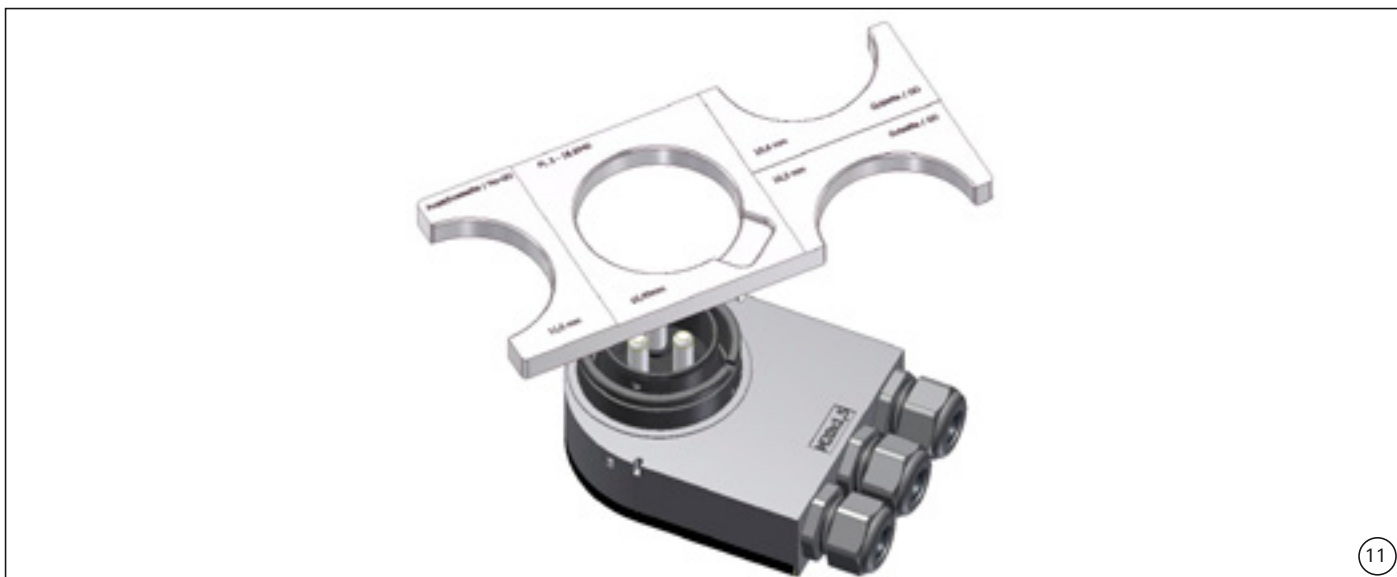
(ill. 11) Nach dem Anziehen muss der Sicherungsring entfernt werden damit die Montagelehre abgezogen werden kann. Anschließend muss der Sicherungsring wieder eingesetzt werden.
